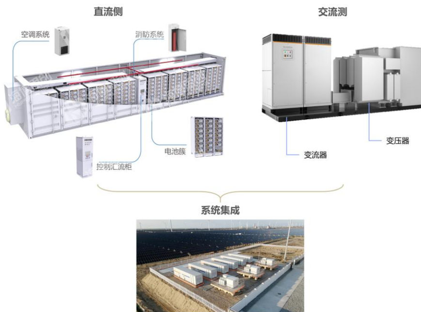
图 18：储能电站系统
